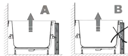
Lors de l'installation d'un bain balnéo, il faut tenir compte du fait que les moteurs et les tuyaux peuvent être placés jusqu'à 20 mm à l'intérieur du bord extérieur de la baignoire. Le bain doit être parfaitement soutenu par les pieds fournis sur une surface plane et égale.
