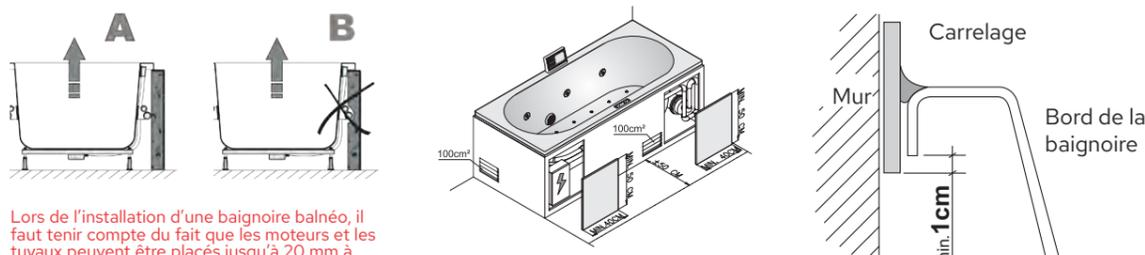
Lors de l'installation d'une baignoire balnéo, il faut tenir compte du fait que les moteurs et les tuyaux peuvent être placés jusqu'à 20 mm à l'intérieur du bord extérieur de la baignoire. Le bain doit reposer sur les pieds posés sur une base solide.
